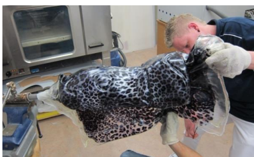
4 Mit Vacuum wird der 160°Grad heisse Kunststoff aufgezo-gen
