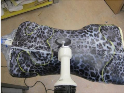
14 Nach 12 Std Abkühlen wird das Korsett aufgeschnitten
