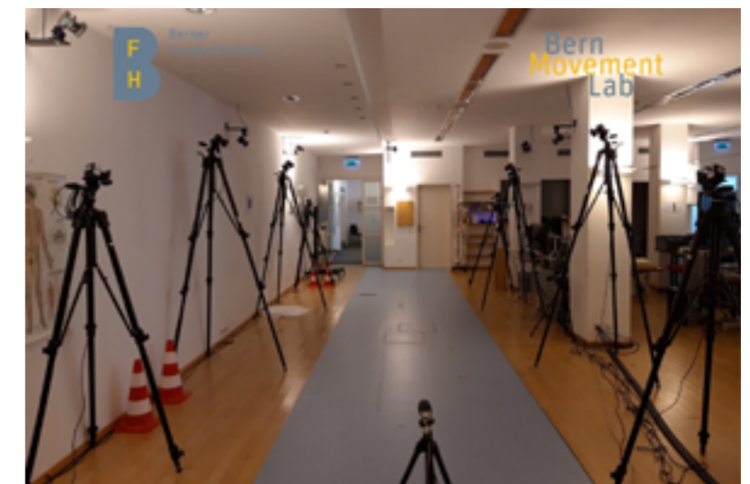
Abbildung 2: Blick auf das 16-Kamera optoelektronische Bewegungsanalyse-System im Bern Movement Lab der Berner Fachhochschule.
